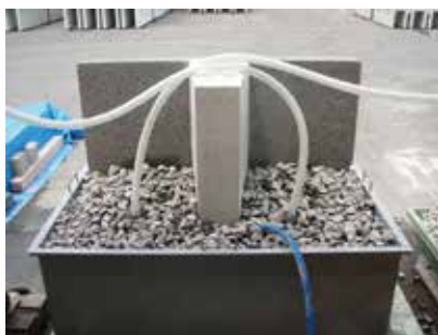
実物敷設状態による排水試験
